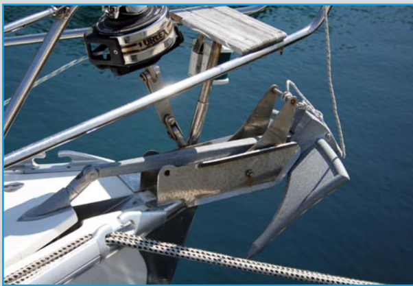
Kotva ve svém loži pod předním košem. Zde je dobře vidět i pomocné lanko, kterým je kotva zajištěna ještě o přední koš. (Pozn. editora: V levé části obrázku je vidět, jak dřív kotvy nedoléhá správně do lože a víko kotveny je prohnuté nahoru. Je to tím, že kotva zde není původní a nesedí úplně správně. Takhle poloha víka kotveny má samozřejmě za následek prasknutí jeho laminátu. A bylo to předmětem debat při vracení lodě, i když nakonec charterovka uznala, že za to vážně nemůžeme a že laminát už prasklý byl.)
